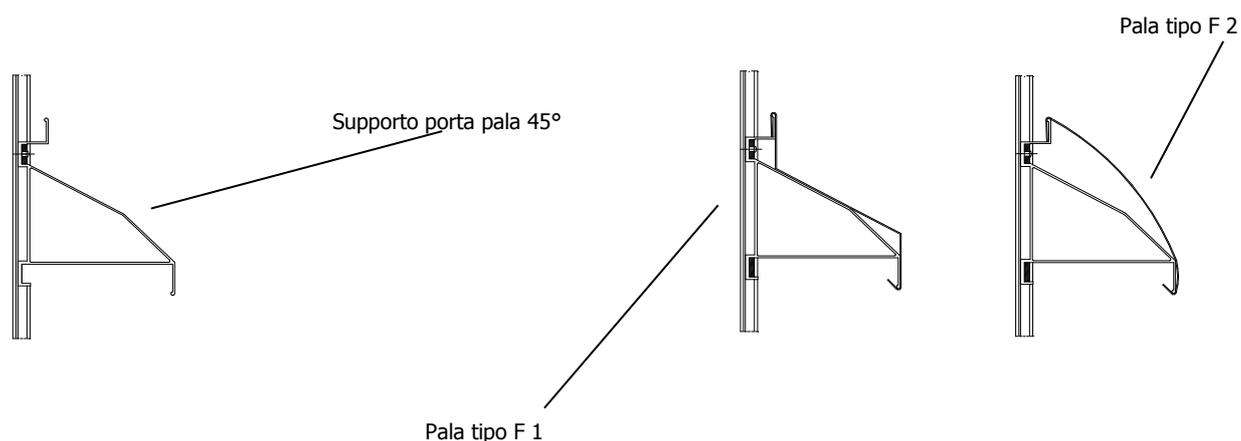
**PORTA DOGHE** Sono realizzate dal taglio di un profilo di alluminio estruso, anodizzato naturale di spessore 25 mm. sui quali vengono agganciate le doghe a scatto. Il porta doghe viene infilato in un canalino in alluminio estruso. Il passo standard tra le doghe è di 153 mm. ma può essere variato a piacere a seconda delle proprie necessità.
